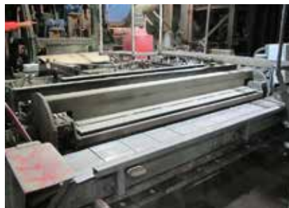
Productie betontegels met kleine tegelpers
