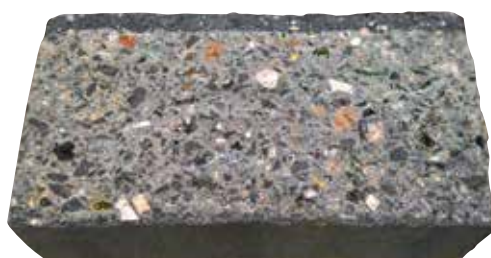
Doorsnede betonstraatsteen met AEC-granulaat
