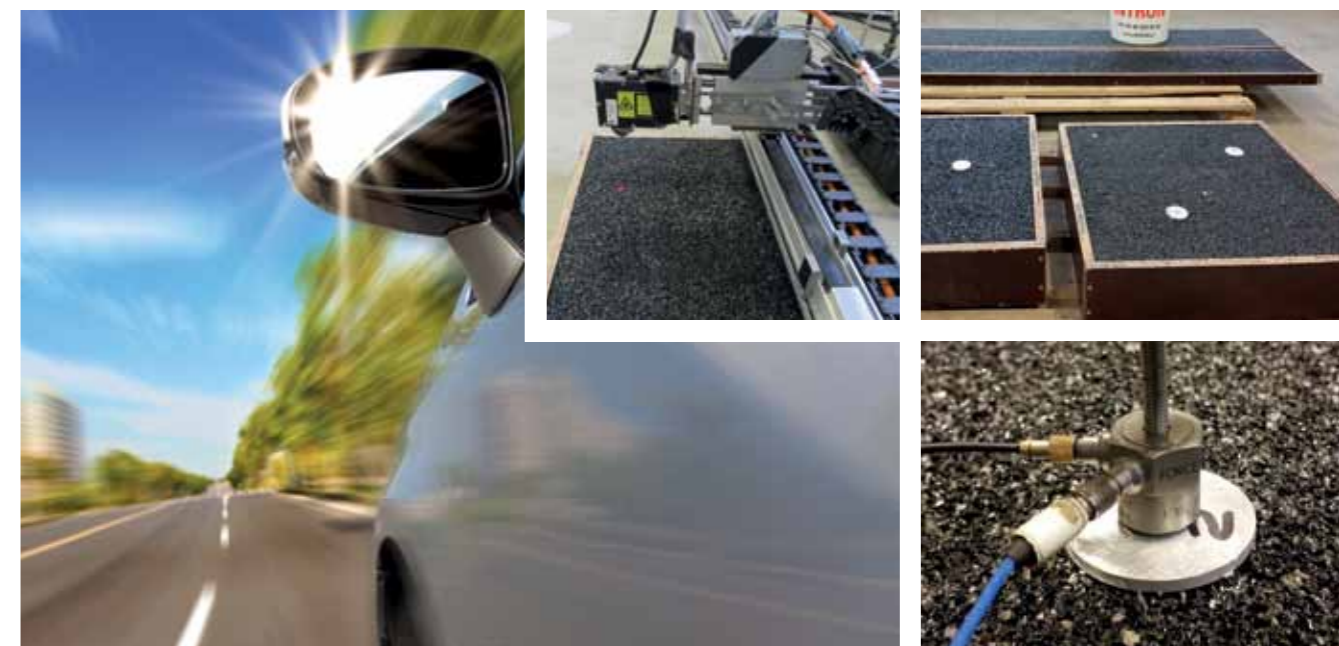
Inzet: Textuurmeting bij akoestisch adviesbureau M+P. Rechtsboven: Overzicht geproduceerde proefstukken voor de pre-screening fase. Rechtsonder: Impedantiemeting bij akoestisch adviesbureau M+P.
