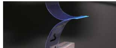
Fig.4 : Délaminage sur le protecteur siliconé du frontal adhésif
