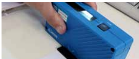
Fig.6 : Mesure de brillance ou réflexion spéculaire suivant NFT30-064 (ISO2813)
