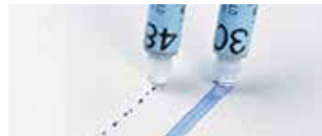
Fig. 9 : Application de la solution d'essai sur le support à tester
